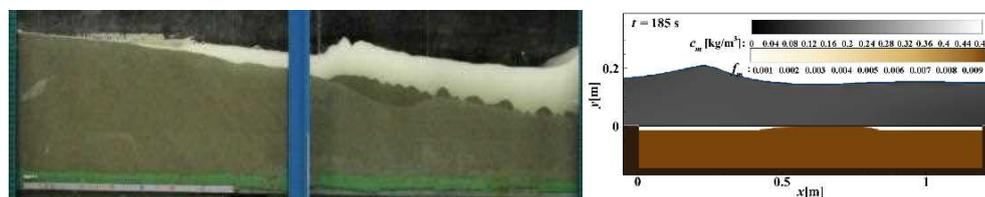
図-2 混合土砂の移動特性 (左：細粒分の流失, 右：細粒分の流失を考慮したモデルの構築)
