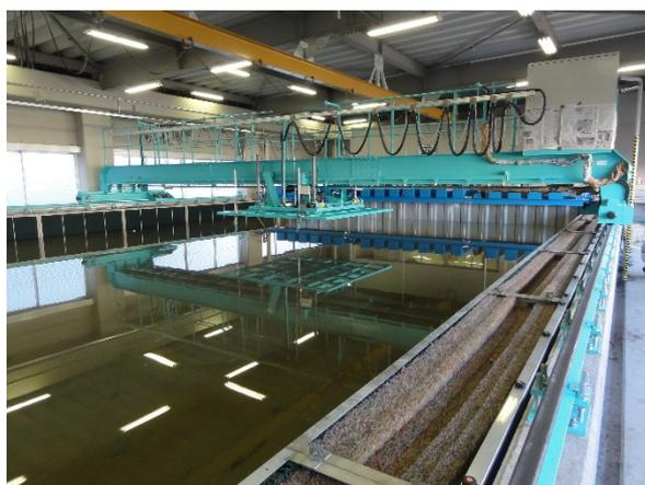
造波装置・計測台車
