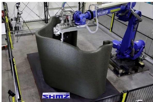
図-3 ロボットによるコンクリート橋脚プリントの状況 (清水建設 HP より)
