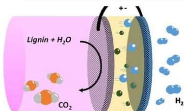
代表例：草本系バイオマスの内、最大の未利用成分であるリグニンから高効率且つ低コストで水素を電気化学抽出。従来法は 1000°C でガス化，本技術は 200°C で電気分解。特許を企業と共同出願。
